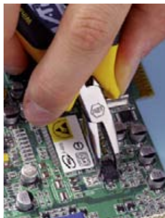
Плоскокруглогубцы Professional ESD используется преимущественно для точных захвата и гибки.
