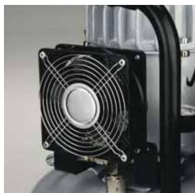
Вентилятор, установленный на компрессоре
