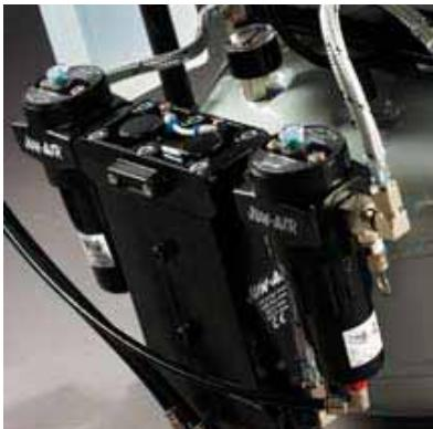
Адсорбционный осушитель D2, установленный на компрессоре
