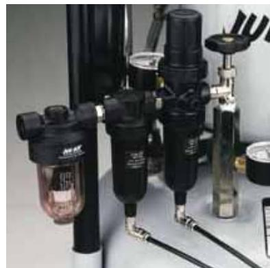
Фильтры, установленные на компрессоре
